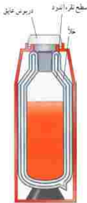
شکل ۱۳. دمپیان خلا می‌تواند مدت نسبتاً زیادی دمای جسم را تقریباً ثابت نگه دارد.
