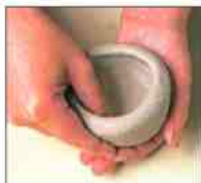
شکل دادن دیواره‌ها برای ساخت کاسه.
