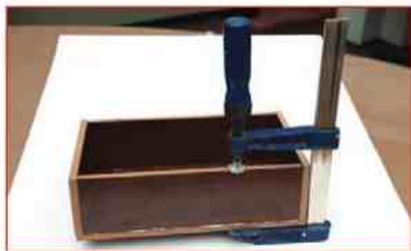
شکل ۹-۱۶. بستن جعبه به وسیله بیج دستی
