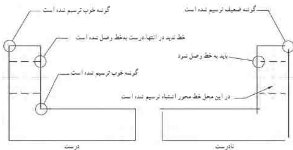
شکل ۳-۸. نمونه‌ای از یک نقشه ترسیم شده خوب و ضعیف
