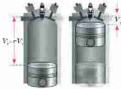
شکل ۱۷-۵ حجم فضای بالای پیستون در ابتدا V_1 و در انتها V_2 است.
