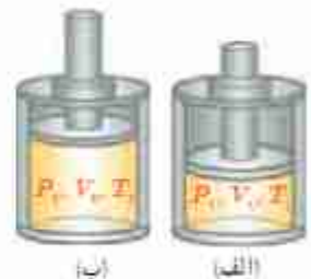
شکل ۵-۲ گاز داخل استوانه در حالت‌های الف) اولیه و ب) نهایی در تعادل ترمودینامیکی است.
