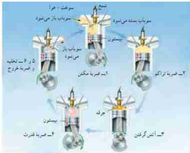
شکل ۱۸-۵ مراحل مختلف در جرقه موتورهای درون‌سوز
