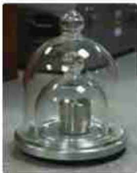
شکل ۱-۱۱ استاندارد ملی کیلوگرم که نسخه دقیقی از استاندارد بین‌المللی سیور فرانسه است. این نمونه در مرکز اندازه‌سناسی در سازمان ملی استاندارد ایران نگهداری می‌شود.
