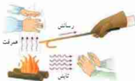
شکل ۴-۵ هر سه روش انتقال گرما را در این تصویر مشاهده می‌کنید.
