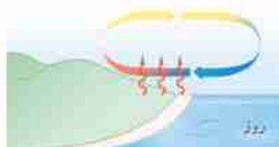
شکل ۴-۴ روز: زمین ساحل گرم‌تر از آب دریاست. پدیدهٔ همرفت موجب نسیمی از سوی دریا به سمت ساحل می‌شود. شب: زمین ساحل سردتر از آب دریاست. پدیدهٔ همرفت موجب نسیمی از سوی ساحل به سمت دریا می‌شود.
