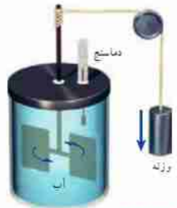
شکل ۳-۴ نمونه‌ای از آزمایش ژول. در این آزمایش نشان داده می‌شود کار نیروی وزن برابر با مقدار گرمای لازم برای افزایش دمای آب است.
