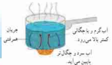
شکل ۴-۳ گرم شدن آب درون قابلمه به روش همرفت
