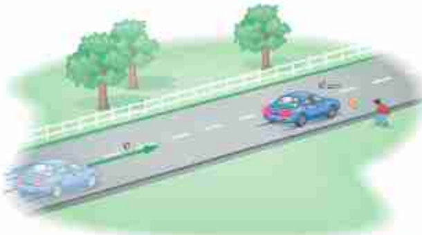
شکل ۴-۸ وقتی خودرویسی ترمز می‌گیرد کار نیروهایی که برخلاف جهت جابه‌جایی خودرو به آن وارد می‌شوند، انرژی جنبشی خودرو را کاهش می‌دهند.
