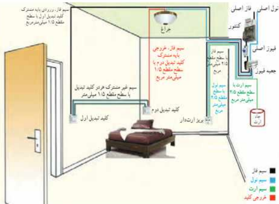
شکل ۱۸-۶ - سیم‌کشی مدار کلید تبدیل
