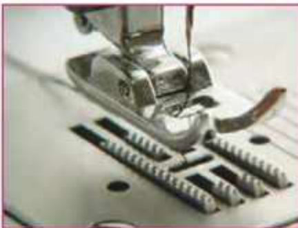
ب- ساز و کار حرکتی شانه(دندان) کار بیش تر جرخ خیاطی
