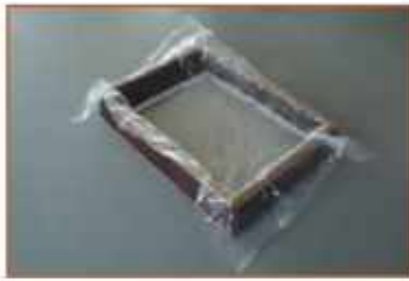
ب - قرار دادن نایلون در قالب شکل ۸-۲۰ - تهیه قالب
