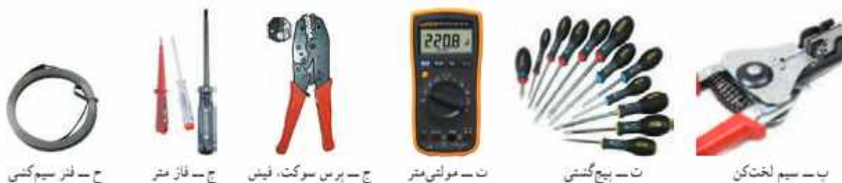
شکل ۶-۳ - تعدادی از ابزارهای سیم‌کشی برق ساختمان
