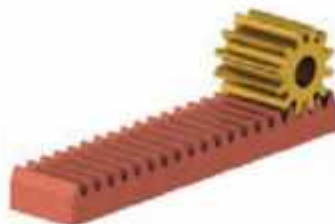
ت- ساز و کار حرکتی چرخ دنده شانه‌ای ساده
