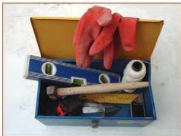
شکل ۸-۱۰ برخی از ابزار مورد نیاز دیوار چینی
