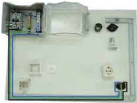
شکل ۱۰-۶- انجام سیم‌کشی بریز ۱
