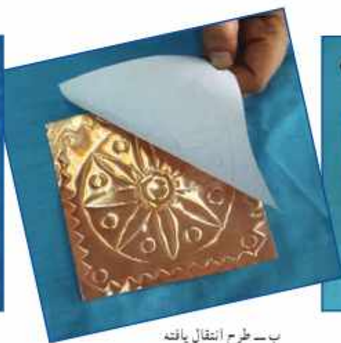
شکل ۱۱-۴ نحوه انتقال طرح روی ورق مسی
