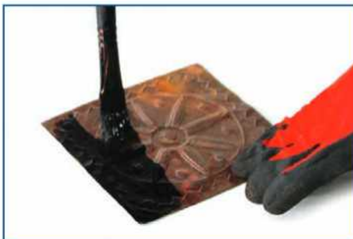
شکل ۱۱-۱۰ - آغشته کردن سطح پلاک مس به قیر
