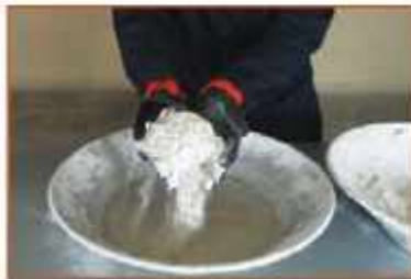
ب - اضافه کردن گچ به آب
