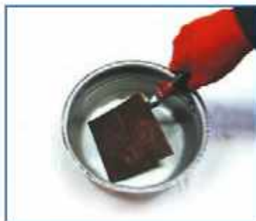
شکل ۹-۱۱- سرد کردن پلاک مسی با آب
