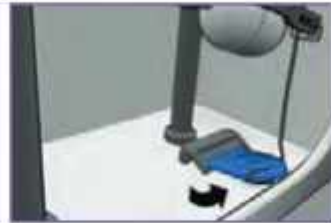
ج - اطمینان از نبودن زنجیر یا هر شیء خارجی در زیر دریوش تخلیه
