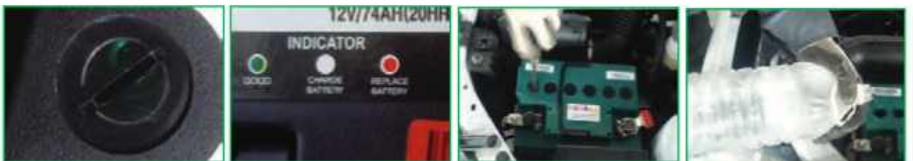
ح - رنگ سبز چشمی، نشانه شارژ بودن باتری است.
