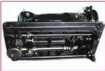
ب- ساز و کار حرکتی بادامک در جرخ خیاطی
