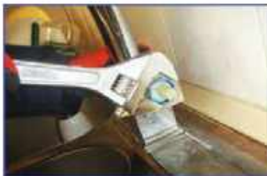
ت- باز کردن بیج روی مغزی (گلند)
