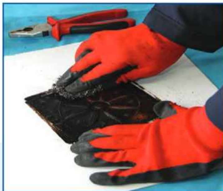
شکل ۱۱-۱۱ - ساب زدن سطح پلاک مس
