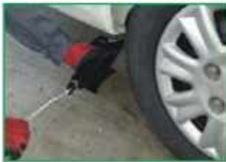
ت- جک را در محل مناسب، زیر خودرو قرار دهید ولی خودرو را بالا نبرید.
