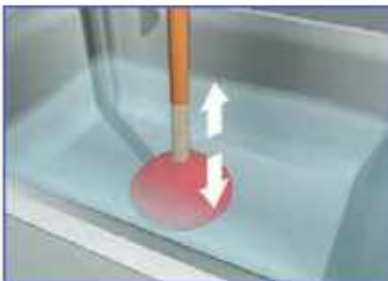
ب - حرکت عمودی لوله بازکن
