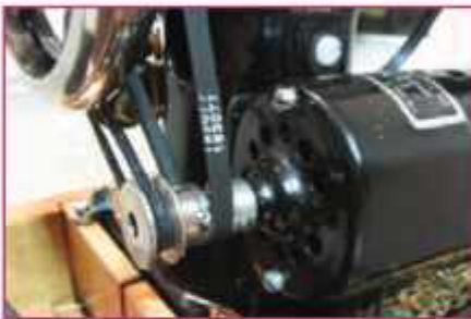
الف- ساز و کار حرکتی تنمه و جرخ تنمه در جرخ خیاطی
