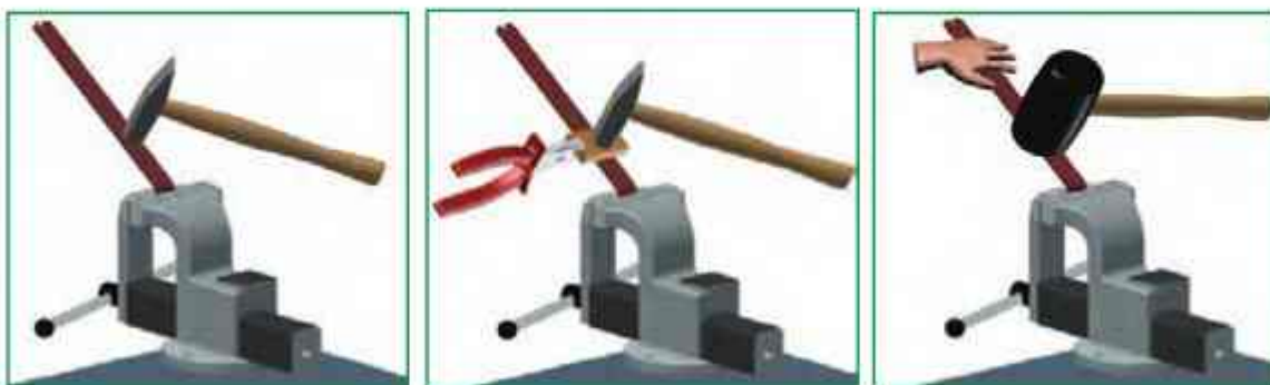
ب) خم کاری با چکش فلزی
