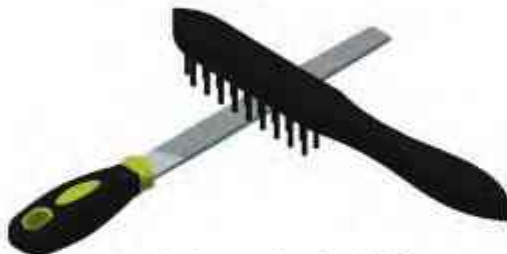
شکل ۱۷-۵. تمیز کردن سوهان با برس سیمی
