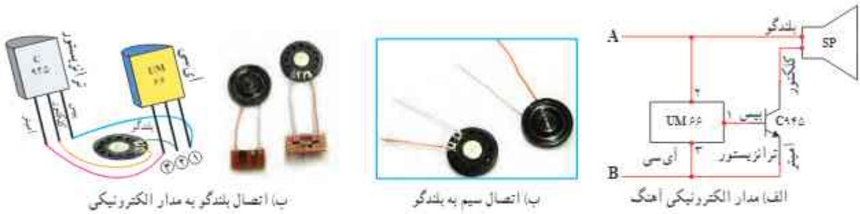
شکل ۴-۲۶. مدار الکترونیکی جعبه آهنگ
