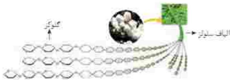
شکل ۳. تپلی ساده از الیاف سلولز و مولکول‌های سازندهٔ آن در پنبه
