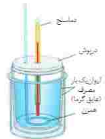
شکل ۸. ساختار گرماسنج لیوولی دستگاهی که به کمک آن می‌توان گرمای واکنش را در فشار ثابت به روش تجربی تعیین کرد. این گرماسنج برای تعیین \Delta H فرآیندهای انحلال و واکنش‌هایی که در حالت مخلوط انجام می‌شوند، مناسب است.
