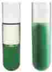
شکل ۱- کلوئید پایدار شده آب و روغن با استفاده از صابون (البته برای تمایز بهتر به آب دو قطره رنگ افزوده شده است).
