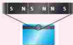
الف) داده ها را به صورت صفر و یک در توار مغناطیسی پشت کارت ذخیره می کنند.
