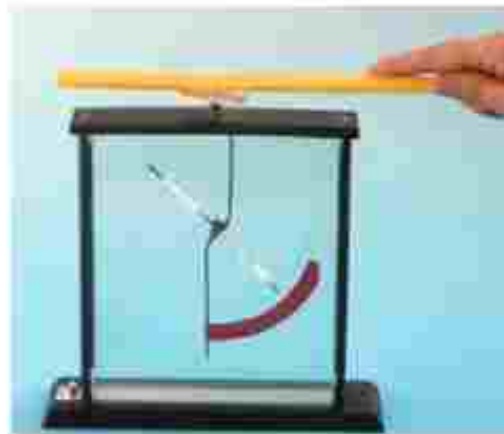
تبار جنسی بارها را به کلاهی الکتروسکوپ بدون بار نزدیک کرده با تماس داده‌ایم.
