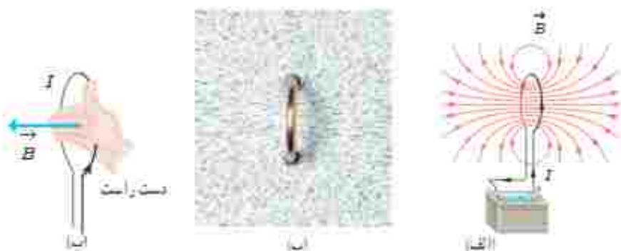
شکل ۳-۱۷ الف) خط‌های میدان مغناطیسی در اطراف یک حلقه حامل جریان. ب) طرح خط‌های میدان مغناطیسی یک حلقه حامل جریان با استفاده از براده آهن. ب) استفاده از قاعده دست راست برای تعیین جهت \vec{B} یک حلقه حامل جریان.
