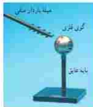
شکل ۲۷-۱ نزدیک کردن میله باردار منفی به گوی فلزی خنثایی که روی پایه عایق قرار گرفته است. صوب ایجاد بارهای القایی مثبت و منفی در در طرف گوی فلزی می‌شود.
