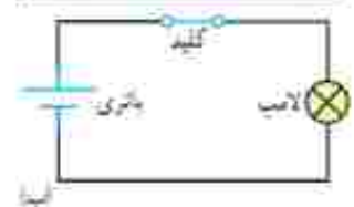
شکل ۲-۴ القاء یک مدار الکتریکی ساده که از لامپ باتری، کلید و سیم‌های رابط تشکیل شده است. به‌عنوان برای رسم مدار از نمادهای استاندارد شده‌ای برای نشان دادن اجزای مدار استفاده می‌شود.
