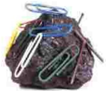
شکل ۱-۱ سنگ آهنربای طبیعی - تالسی که اغلب از او به عنوان مدر علم یونان یاد می‌شود. ماده گالی مگنتیت (Fe 3 O 4 ) را که ویژگی آهنربایی دارد می‌ساخت.
